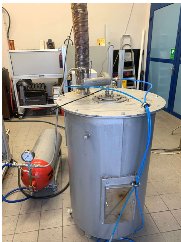
Rys. 18 Zdjęcie stanowiska laboratoryjnego do eksperymentu pirolizy.
